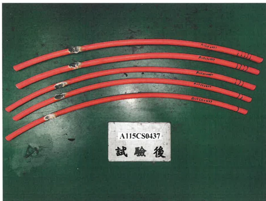
圖二、燃燒後，試片之狀況
